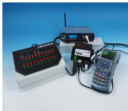
Benötigt man gar mehrere CAN-StellPulte an einem StellPult, kann man durch die auf der Rückseite vorhandenen zwei Buchsen auch Geräte direkt miteinander verbinden. Auch hierfür ist ein passendes Kabel erhältlich.
