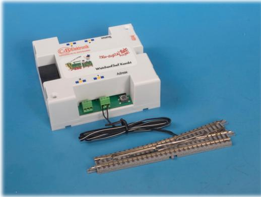
Auch die magnetischen Antriebe von Kato oder Rokuhan werden lediglich an die zwei äußeren Klemmen angeschlossen, da sie durch ein sehr kurzes Umpolen der Versorgungsspannung bewegt werden.
